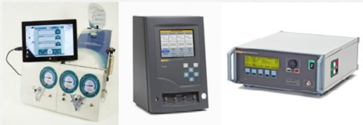
Figura 54 – Equipamentos utilizados para verificação de equipamentos eletromédicos
